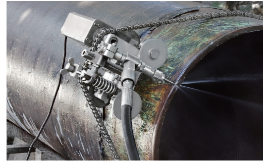
Гидроабразивная резка стальных труб
